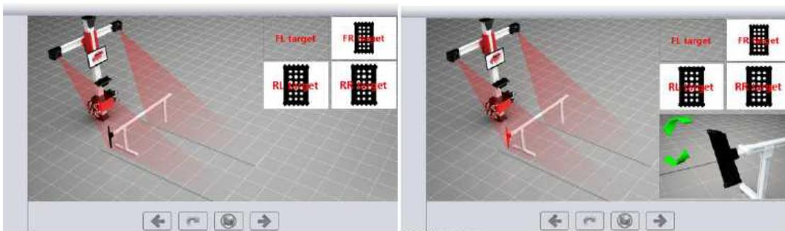
Затем кликните еще раз. Когда мишень на экране загорится красным и появится подсказка в нижней правой части экрана, поворачивайте мишень против часовой стрелки до тех пор, пока не загорятся все индикаторы. При появлении на экране стрелок в обратном направлении вращайте мишень по часовой стрелке до тех пор, пока не загорятся все индикаторы. Когда мишень на экране загорится зеленым, калибровка окончена.
