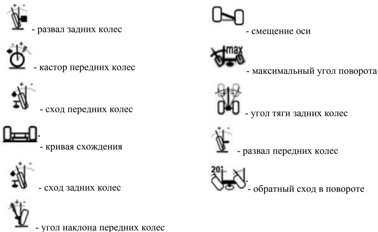
Для регулировки нужного угла выберите соответствующее поле. Пользователь может выбрать режим отображения одного угла или режим отображения углов одного колеса.
