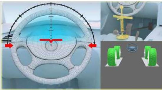
После компенсации перейдите в режим измерений. Установите машину на ручной/ножной тормоз и зафиксируйте педаль ногожного тормоза фиксатором падали. Разблокируйте поворотные круги и сдвижную пластину. Установите руль прямо. Рис. 19.
